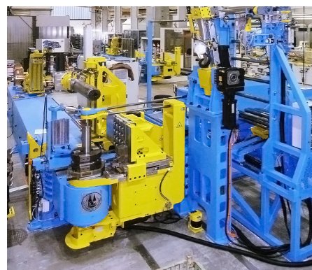
Die Biegezele arbeitet vollautomatisch von der Materialpufferung über die Schweißnahtprüfung bis hin zum Biegen.
