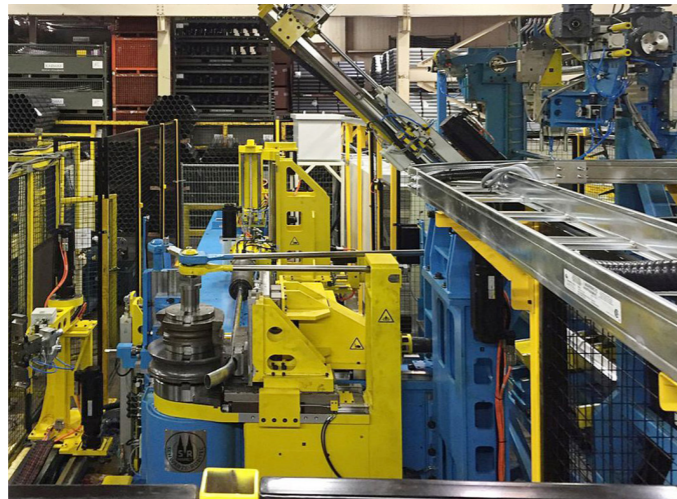
Der von Schwarze-Robitec konstruierte Schwenklader bestückt die Maschine vollautomatisch mit Rohmaterial. Bilder: Schwarze-Robitec
